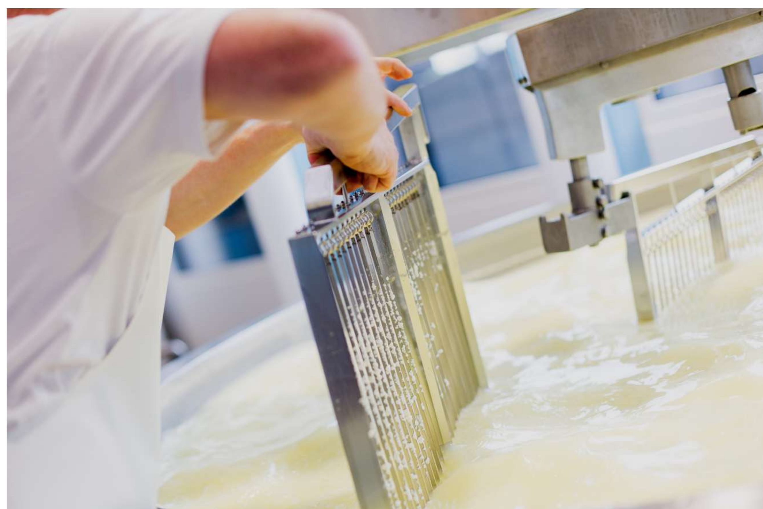
Mit der Käseharfe werden Käsemasse und Sirte getrennt.
